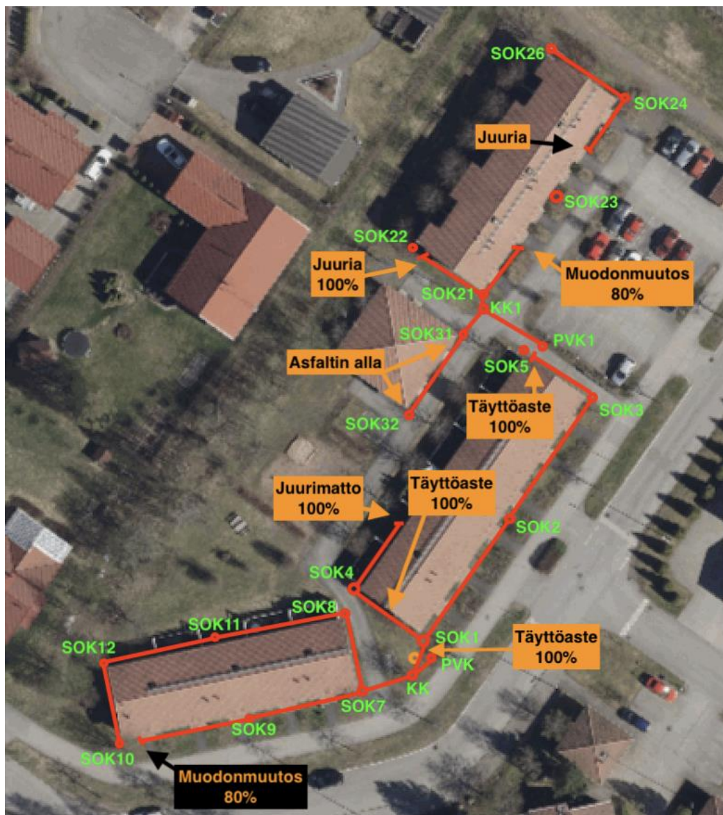
Kuvatut salaojaviemärit. Osa havainnoista merkitty kuvaan.
